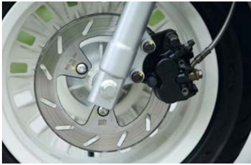
Na prednjem kotaču 200 milimetarski disk odlično usporava i koči kretanje, dok stražnja kočnica kao i da ne postoji
